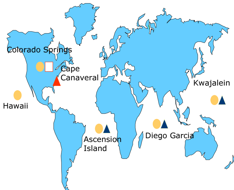
Abbildung 2: Das Control Segment des GPS
